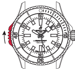
Configuración 1: bisel bloqueado
